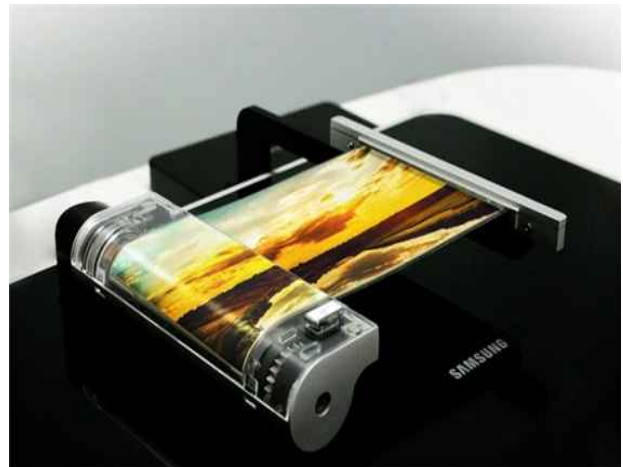
국제디스플레이정보학회(SID) 2016에서 발표한 삼성디스플레이의 5.7인치 컬러 롤러블 디스플레이 (출처: 삼성디스플레이 블로그)
