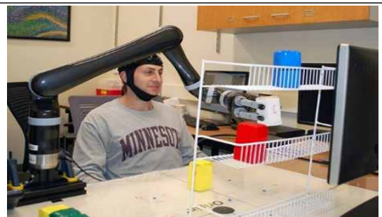
운동 상상으로 로봇팔을 제어하는 기술 (출처: Minnesota University)
