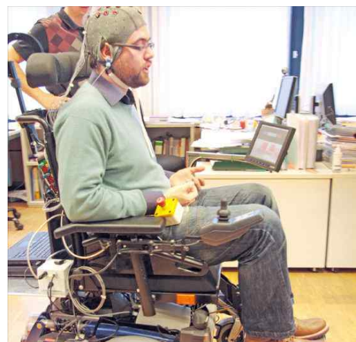
사람의 뇌파를 이용하여 휠체어를 움직이는 기술 (출처: 스위스 로잔공대 BMI 연구센터)
